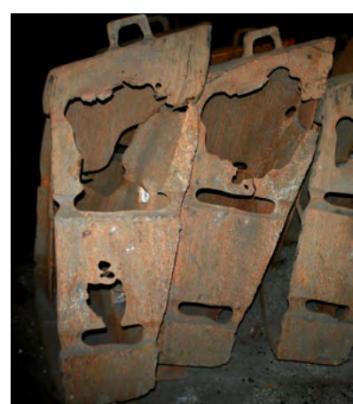
Металлический элеватор мельницы МГР40x75 наработка 23 200 часов износ – 100%
