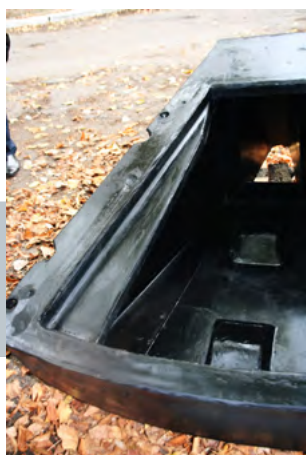
Резинометаллический элеватор мельницы МГР 40x75 наработка 0 часов
