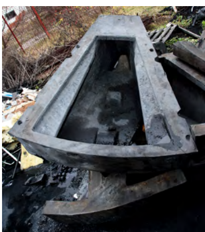
Резинометаллический элеватор мельницы МГР 40x75 наработка 24 000 часов износ – 5%
